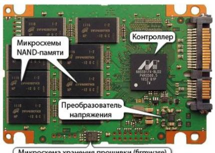
Микросхема хранения прошивки (firmware)
