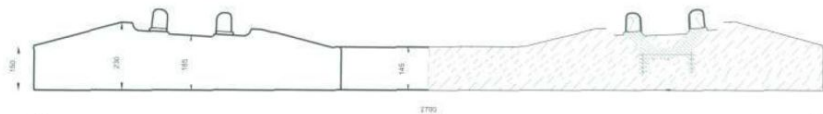
ШПАЛА ЖЕЛЕЗОБЕТОННАЯ АНКЕРНАЯ ТИПА ШС-АРС для бесподкладочного анкерного рельсового скрепления типа АРС-4
