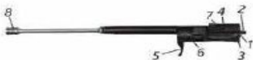
23-сурет. Газ поршеньді бекітпе жақтауы: 1 – бекітпеге арналған арна; 2 – сақтандырғыш шығыңқы; 3 – автоағытқыш тұтқасын босататын шығыңқы; 4 – ұңғы қорабының қабырғасына арналған саңылау; 5 – тұтқа; 6 – фигуралы ойық; 7 – шарғылыстыру шығыңқысына арналған саңылау; 8 – газ поршени
