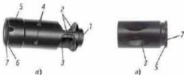
19-сурет. Ұңғылық тежеуіш-компенсатор және жалын сөндіргіш:
