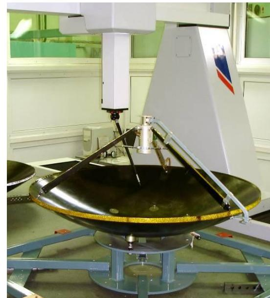
Рис. 10 Рефлектор с углепластиковыми обшивками и алюминиевым наполнителем
