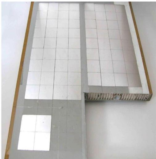
Рис.11. Сотовая панель с покрытием ОСО-С
