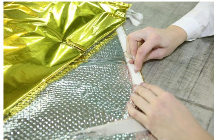
Рис.13. Полиимидная плёнка в составе ЭВТИ
