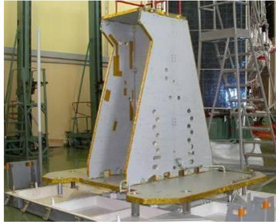
Конструкция из сотопанелей
