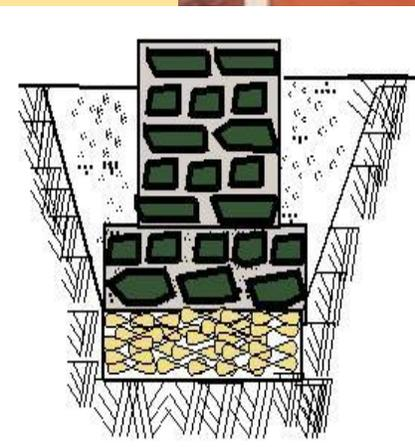
Конструкция бутового фундамента в пучинистых грунтах
