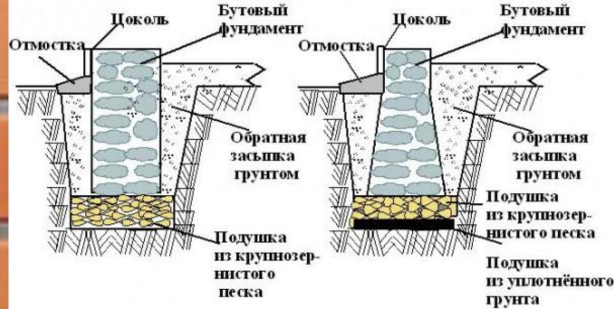
Конструкция бутового фундамента в непучинистых грунтах
