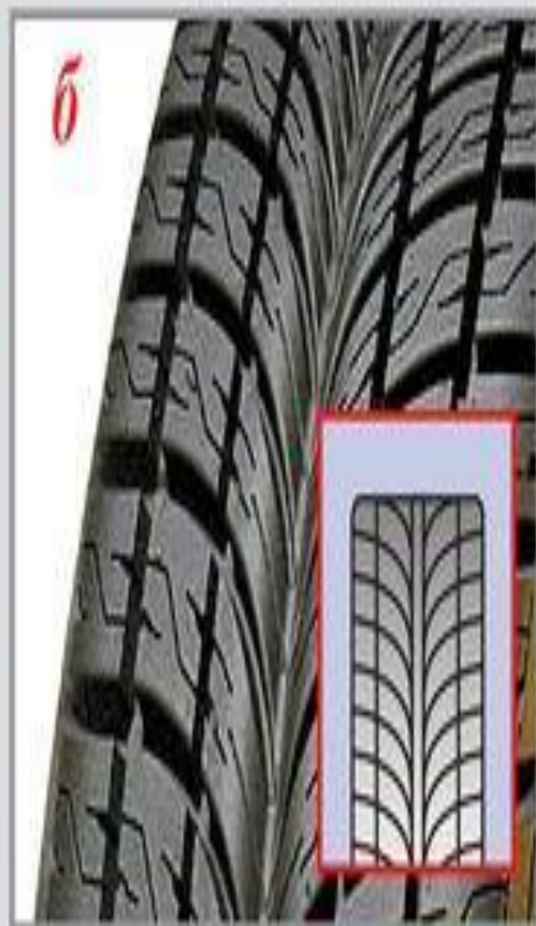
Фото. Дорожные шины с разными типами рисунка: а — ненаправленный; б — направленный; в — асимметричный
