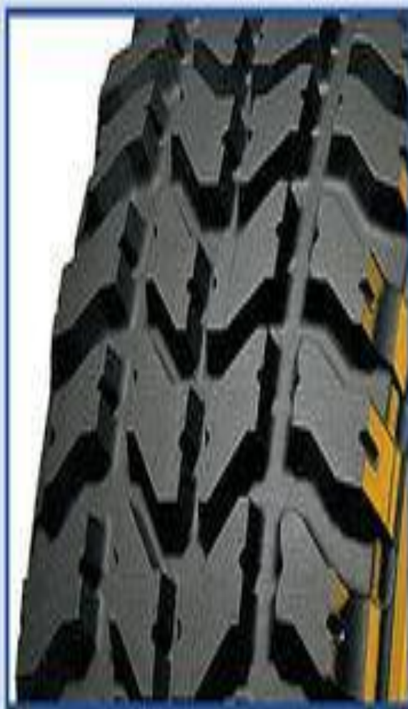
Рис. 3. Шина повышенной проходимости с направленным рисунком
