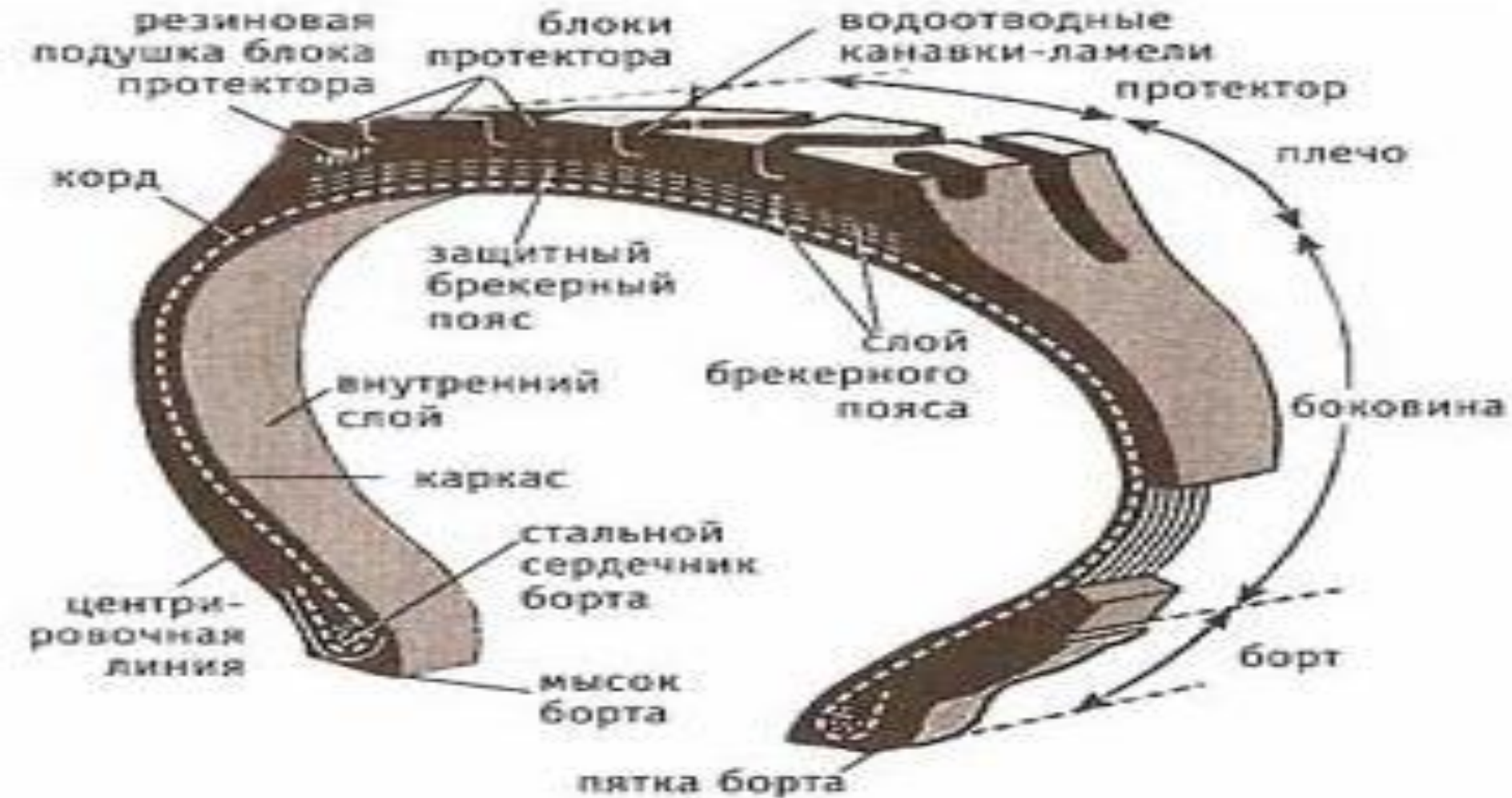
Рис.4. Устройство пневматической шины
