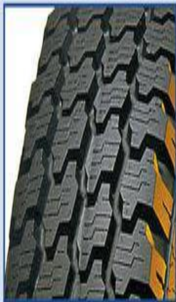
Рис. 2. Универсальная шина с ненаправленным рисунком
