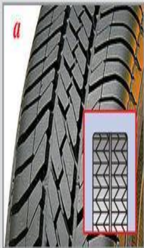
Фото. Дорожные шины с разными типами рисунка: а — ненаправленный; б — направленный; в — асимметричный
