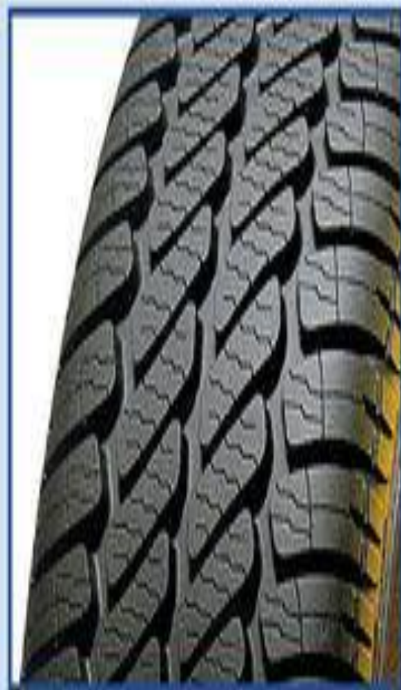
Рис. 4. Всесезонная шина с ненаправленным рисунком
