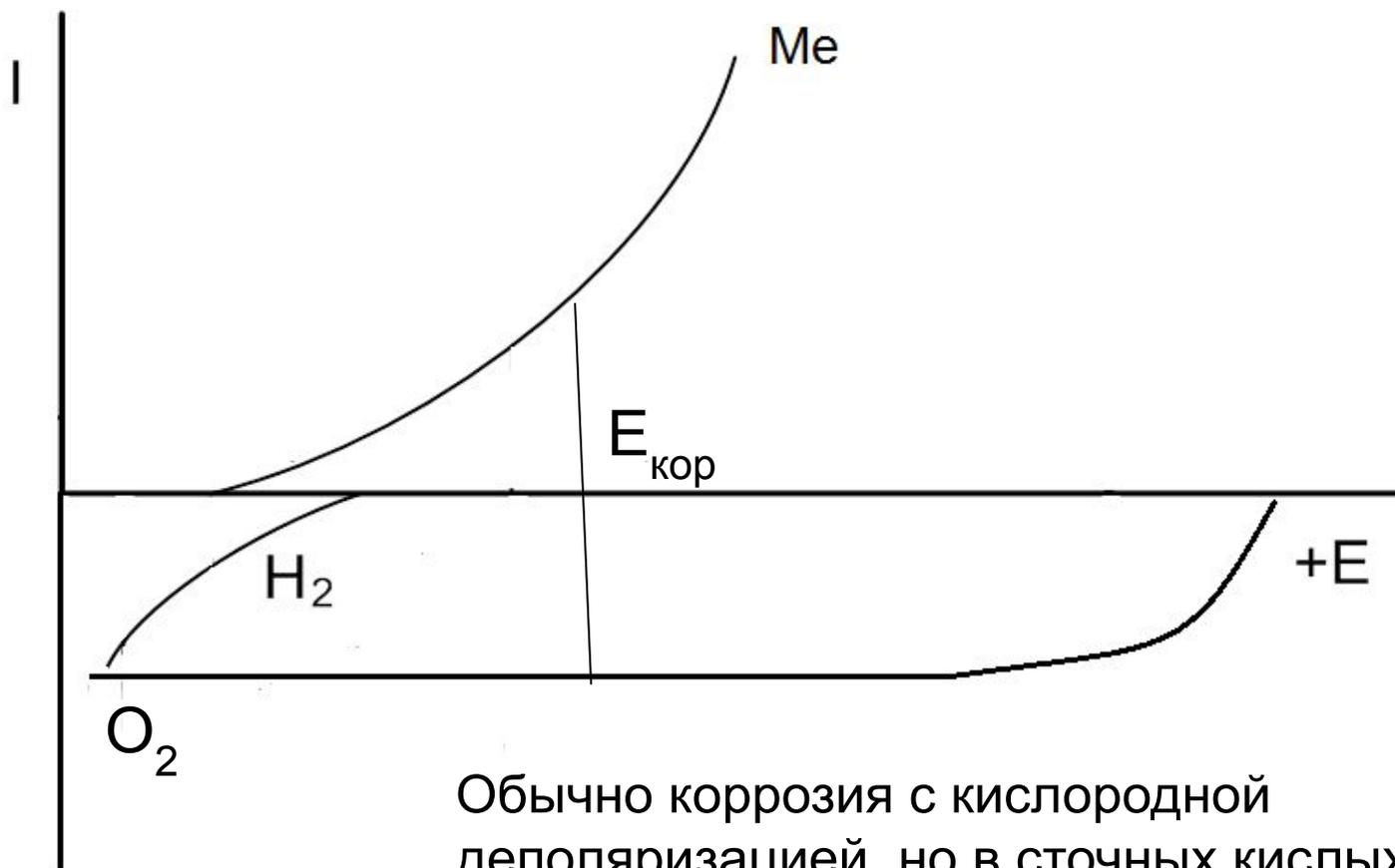
Обычно коррозия с кислородной деполяризацией, но в сточных кислых водах коррозия под действием двух окислителей
