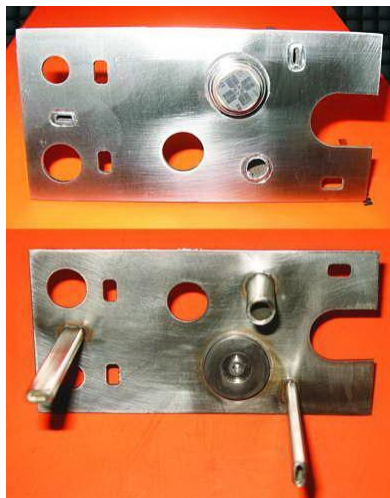
Сварка разнородных материалов (сталь и титан)
