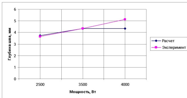
Изменение глубины шва при лазерной сварке
