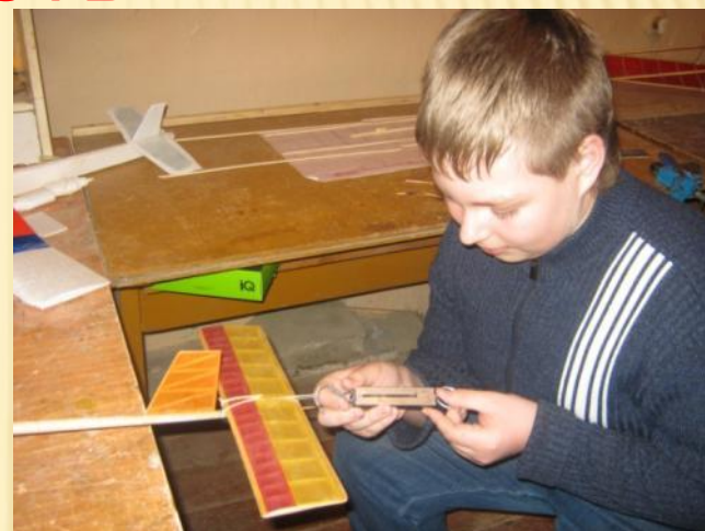
Определение динамометром статической тяги винто-моторной группы
