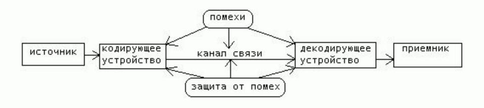
*Канал связи* - совокупность технических устройств, обеспечивающих передачу сигнала от источника к получателю.
