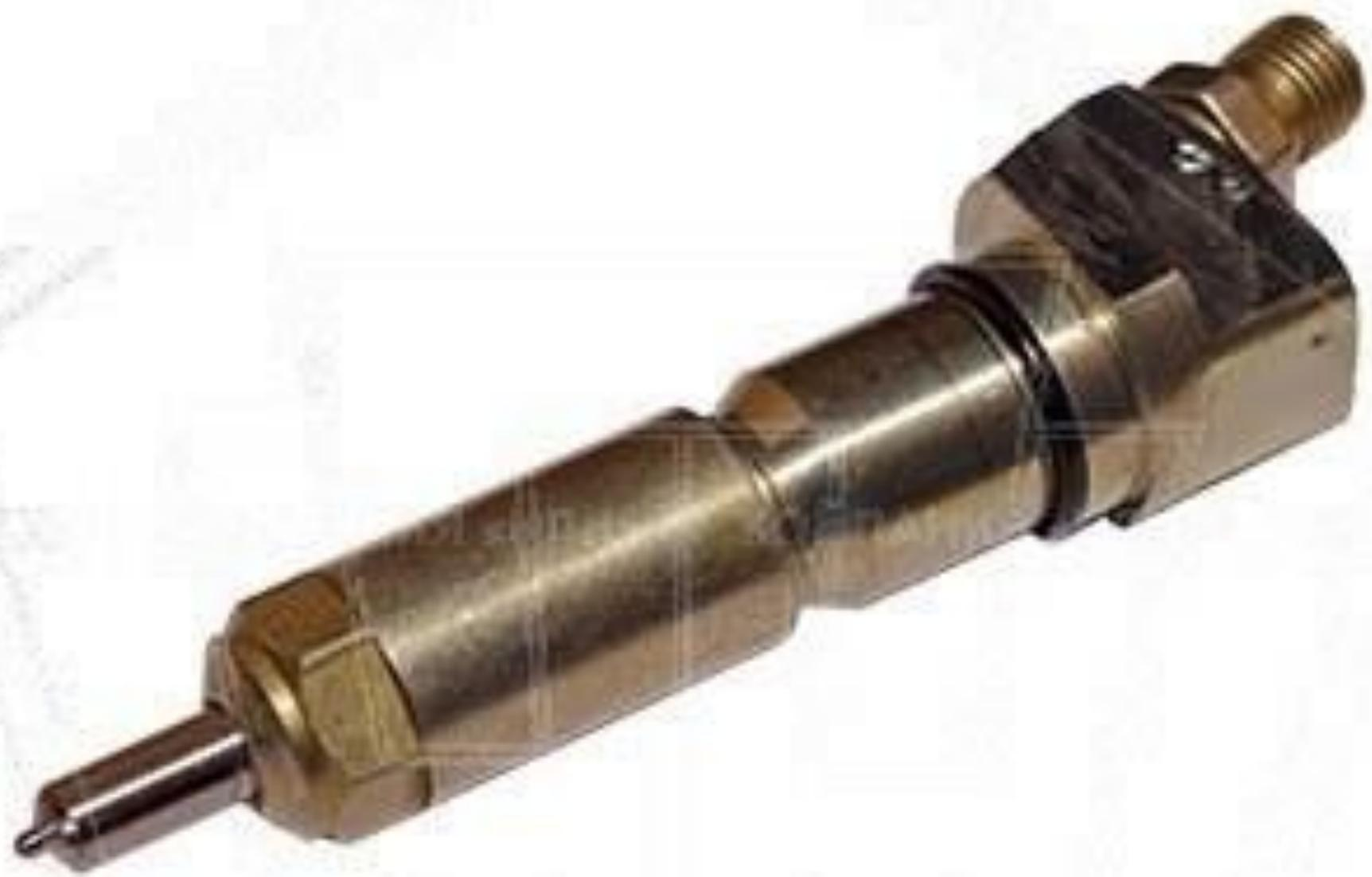
Топливо, поступающее в полость, находится под давлением, создаваемым насосом, и в свою очередь давит на нижний конус иглы. Сопла распылителя открываются тогда, когда давление топлива в полости и на нижнем конце иглы превысит сопротивление пружины.
