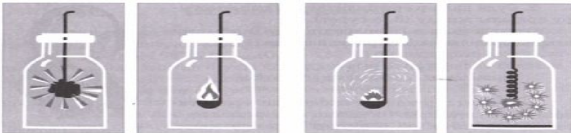
10-сурет. Заттардың: а – көмірдің, ә – күкірттің, б – фосфордың, в – темірдің оттегінде жануы
