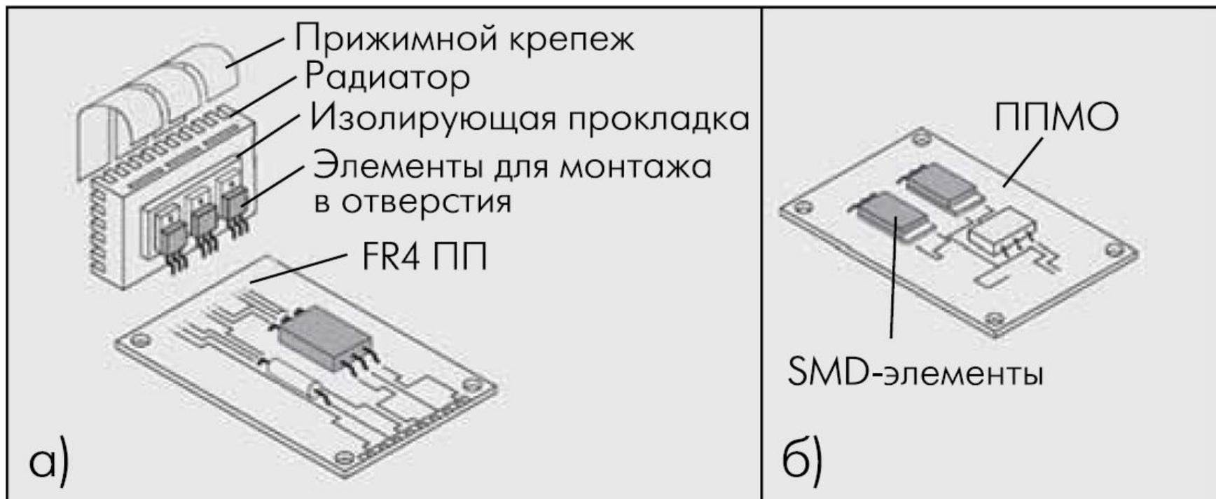
**Рис.3. Упрощение конструкции устройств при применении ППМО:**
