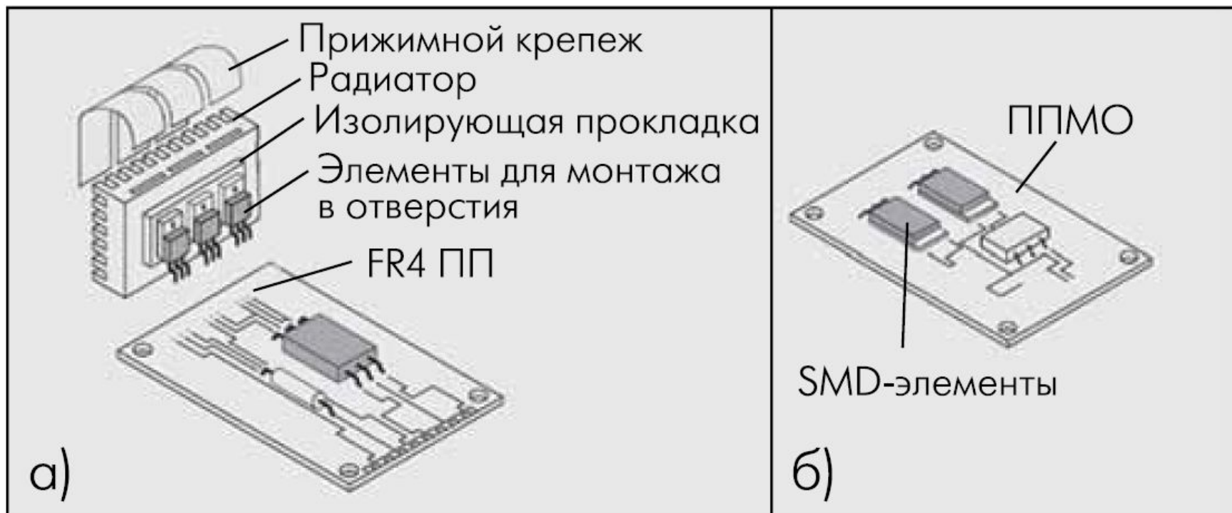
Рис.3. Упрощение конструкции устройств при применении ППМО: а – печатные платы на основе диэлектрика FR4 с компонентами для монтажа в отверстия; б – ППМО с SMD-компонентами
