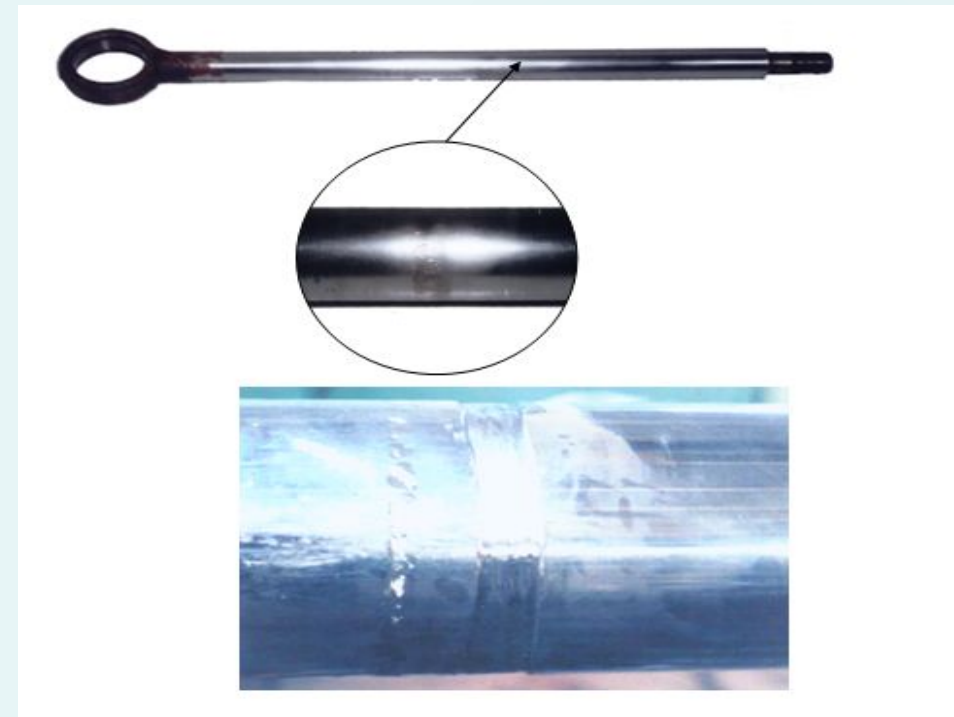
Загальний вигляд абразивного зношування на штоку гідроциліндра рульового керування
