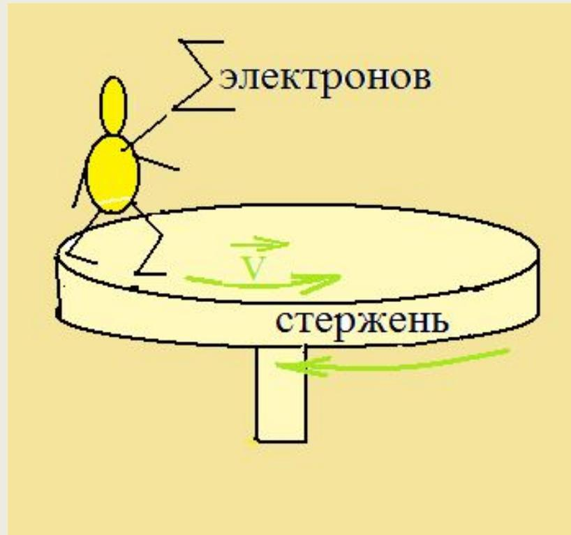
$$I_{\text{ч}} \vec{\omega}_{\text{ч}} - I_{\text{СТ}} \vec{\omega}_{\text{СТ}} = \mathbf{0}$$
