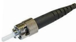
Разъем типа ST использует быстро сочленяемое байонетное соединение, которое требует поворота разъема на четверть оборота для осуществления соединения/разъединения. Применяется как для одномодового, так и для многомодового кабеля. Самый дешевый разъем
