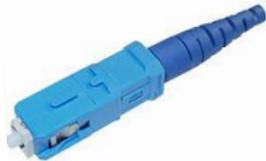
Разъем типа SC широко используется как для одномодового, так и для многомодового волокна. Относится к классу разъемов общего пользования. В разъеме используется механизм сочленения «push-pull», при котором соединитель защелкивается. Может объединяться в модуль, состоящий из нескольких разъемов. В этом случае модуль может использоваться для дуплексного соединения (одно волокно которого используется для передачи в прямом, а другое в обратном направлениях).
