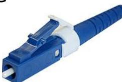
Разъем типа LC миниатюрный вариант SC. Он обеспечивает еще большую плотность монтажа. Помещен в прочный термостойкий пластмассовый корпус типа с механизмом «push-pull». Может использоваться для дуплексного соединения.
