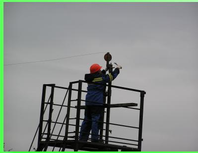
Производится спуск пробоотборника на глубину отбора закрытой пробы.
