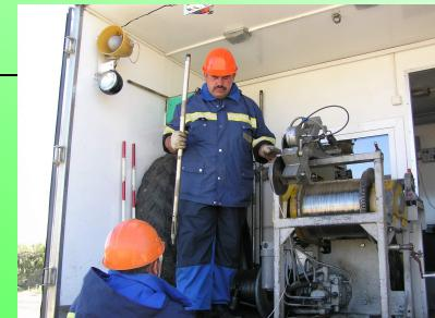
Спуск электронного манометра производится на глубину отбора закрытой пробы.
