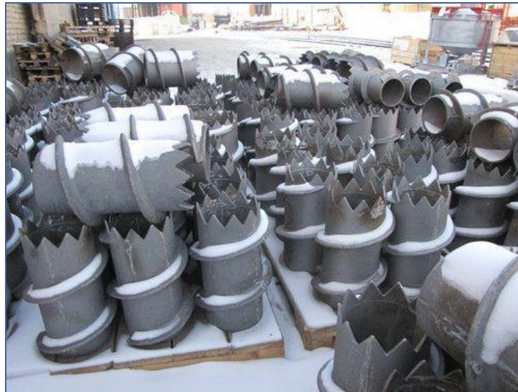
Фото 4. Оголовки свай для мерзлых грунтов
