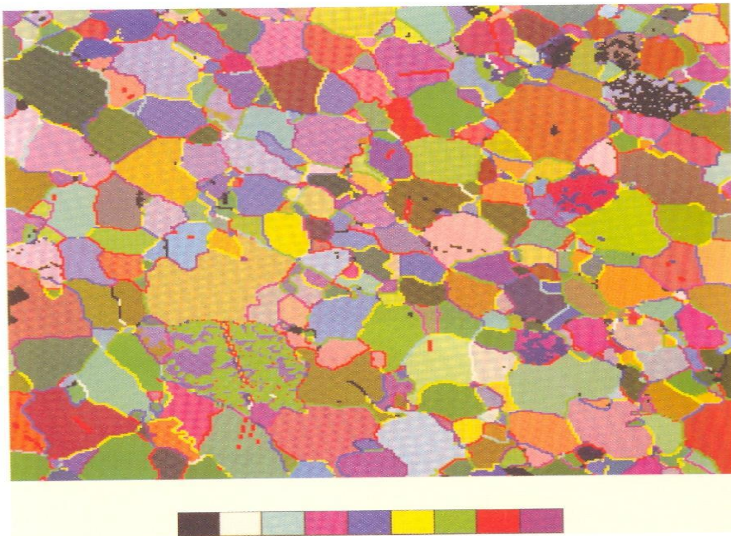
Фото 3. Карта ориентации зерен кальцита в мраморе, выделенная из EBSD-изображения; дезориентация по границам, раскрашенная согласно показанной шкале (0–90°). (См. раздел 4.8.3.) (С разрешения G. Lloyd.)
