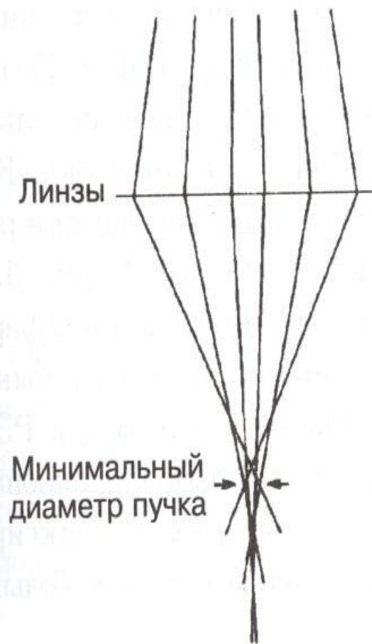
Рис. 3.6. Сферическая аберрация: линзы фокусируют внешние лучи пучка сильнее, чем те, которые ближе к оси, в результате чего в фокусе диаметр пучка размывается
