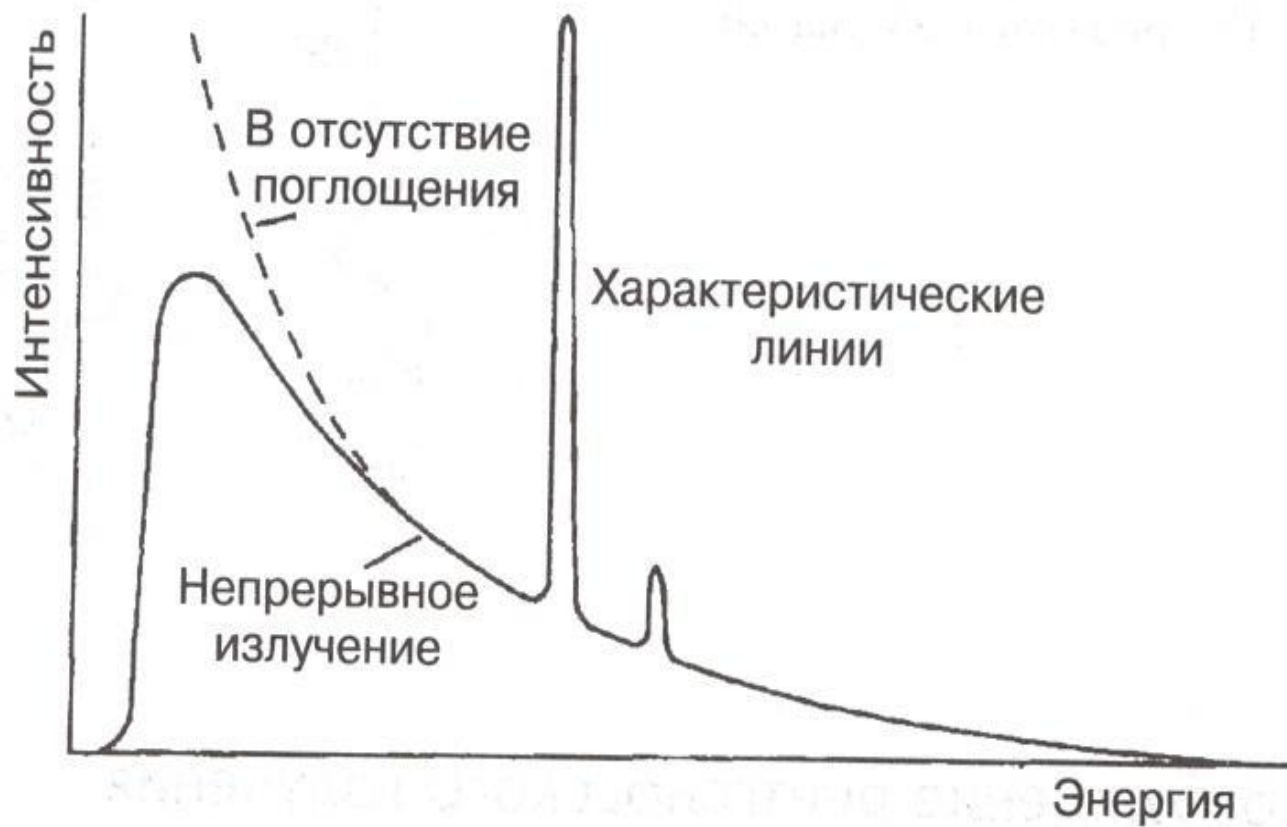
Рис. 2.6. Рентгеновский спектр, построенный в зависимости от энергии фотона, показывающий характеристические линии на фоне непрерывного рентгеновского спектра (или «континуума»), возбужденного падающими электронами с учетом неупругих взаимодействий с ядрами атомов. Наблюдаемое падение интенсивности непрерывного рентгеновского излучения при низких энергиях связано с поглощением в окне детектора и т. п.
