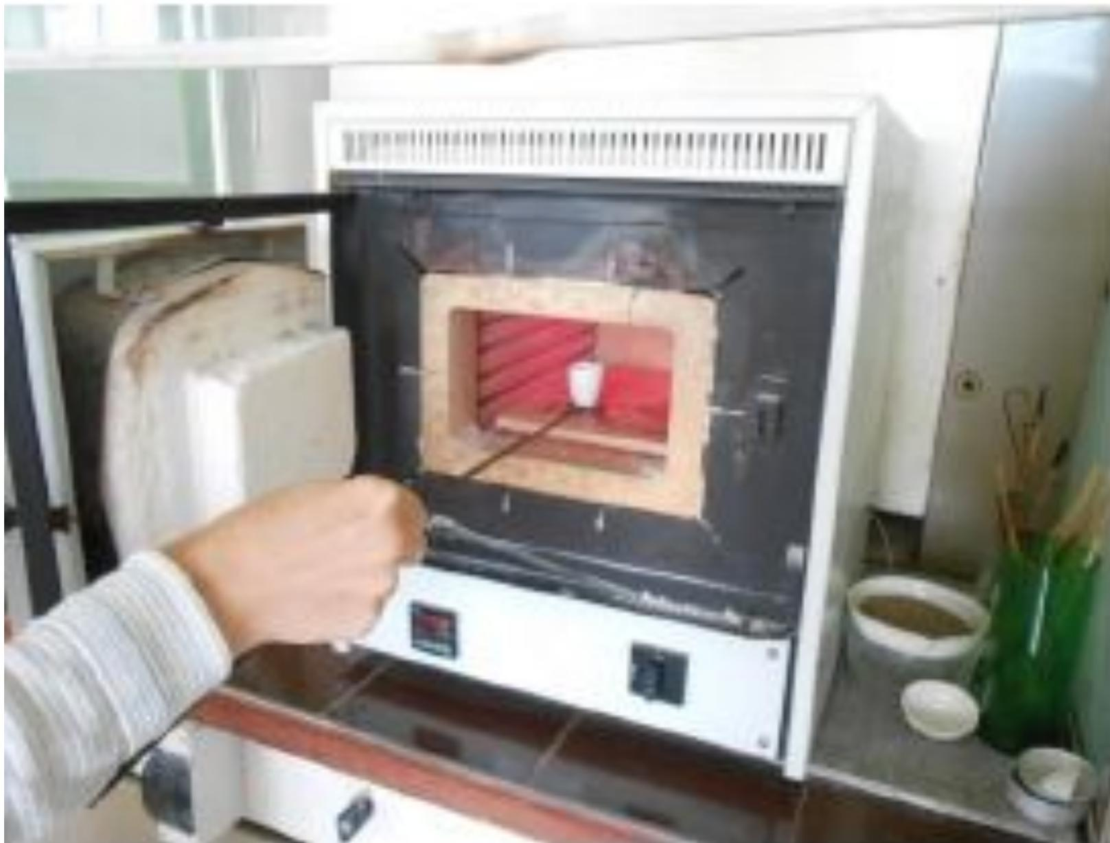
**Прокаливание тигля в муфельной печи**
