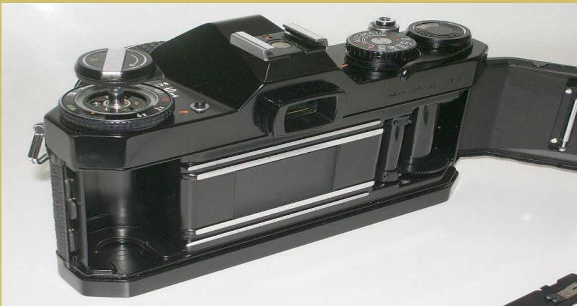
Затвор на плёночной камере при открытии крышки сзади
