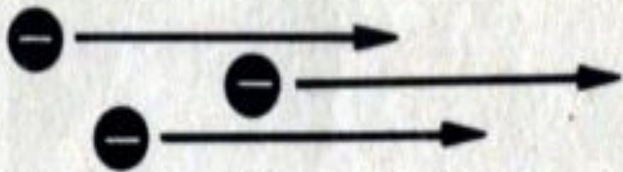
Бета-лучи – поток электронов, вылетающих из ядер со скоростью, близкой к скорости света.
