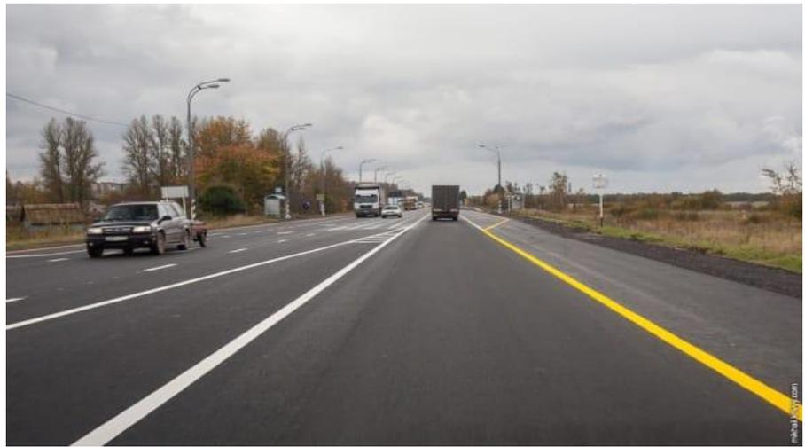
**Дорожная разметка 1.4 представляет собой одинарную сплошную линию желтого цвета, шириной от 10 до 20 см. Обозначает места, в которых запрещается остановка и стоянка ТС.**
