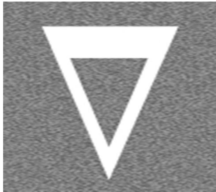
**Разметку 1.20 применяют для предупреждения о приближении к разметке 1.13 (уступи дорогу – ряд белых треугольников) на дорогах с высокой интенсивностью движения. Ее наносят на каждой полосе движения. Расстояние между основанием треугольника разметки 1.20 и разметкой 1.13 может составлять от 2 до 25 метров.**
