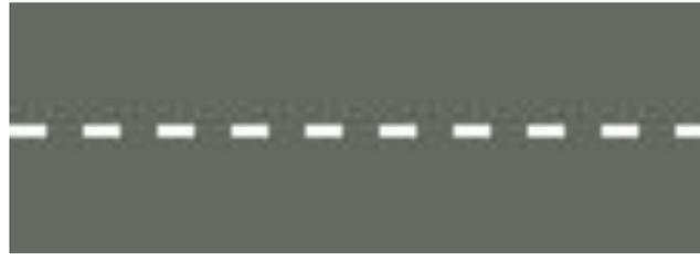
**Разметка обозначает полосы движения на перекрестке.**
