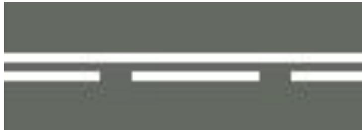
**Линию 1.11 разрешается пересекать со стороны прерывистой линии, а также и со стороны сплошной линии, но только при завершении обгона или объезда.**
