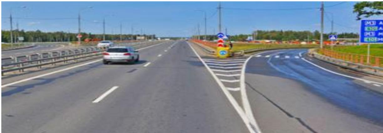
**Разметку 1.16.3 применяют для обозначения направляющих островков в местах слияния транспортных потоков. Внешне разметка 1.16.3 и 1.16.2 похожи, на дороге разница не ощущается.**
