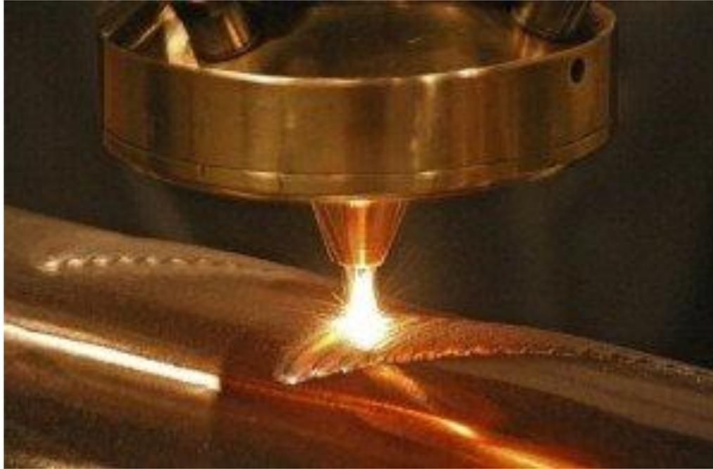
В зависимости от условий эксплуатации оборудования, это могут быть высокая эрозионная, кавитационная, коррозионная, износо- жаростойкость и другие. В случае обработки новых деталей наплавка позволяет значительно сэкономить на материале, так как отпадает необходимость изготовления изделия целиком из дорогого сплава. Также во всех случаях использования этой технологии значительно продлевается срок службы обработанных узлов и деталей.
