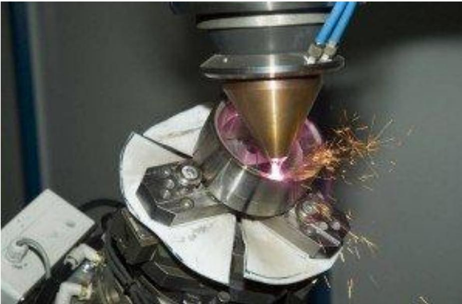
Качество напыления лазером зависит от очень многих параметров, но главным является расход порошка. Задав необходимый диаметр луча, мощность лазера и скорость наплавки, массовым расходом твердосплавного состава можно регулировать толщину наносимого покрытия, разжижение и твердость
