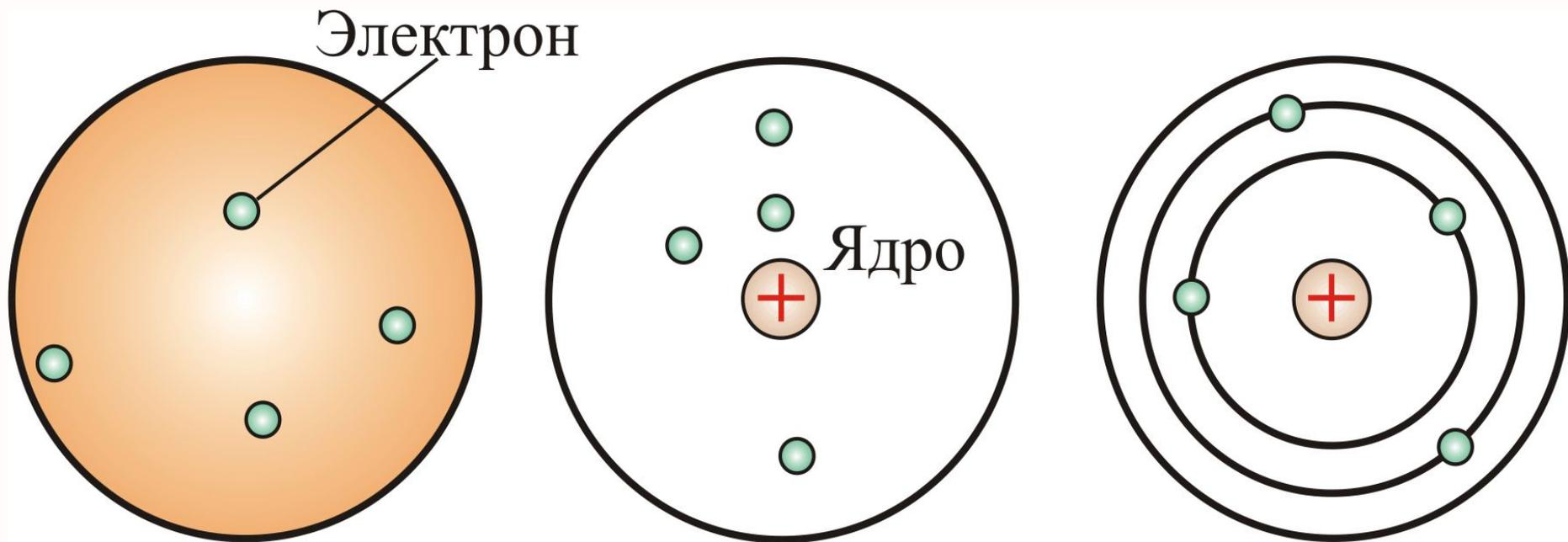
Однако, *такая модель была в явном противоречии с классической электродинамикой*, т.к. *электрон, двигаясь по окружности*, т.е. с нормальным ускорением, *должен был излучать энергию, следовательно, замедлять скорость и упасть на ядро*. Таким образом, модель Резерфорда не могла объяснить, почему атом устойчив.
