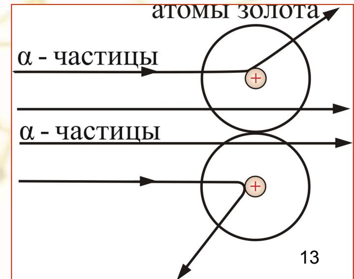
Узкий пучок  $\alpha$ -частиц испускался радиоактивным веществом и попадал на фольгу. При прохождении через фольгу  $\alpha$ -частицы отклонялись на различные углы.
