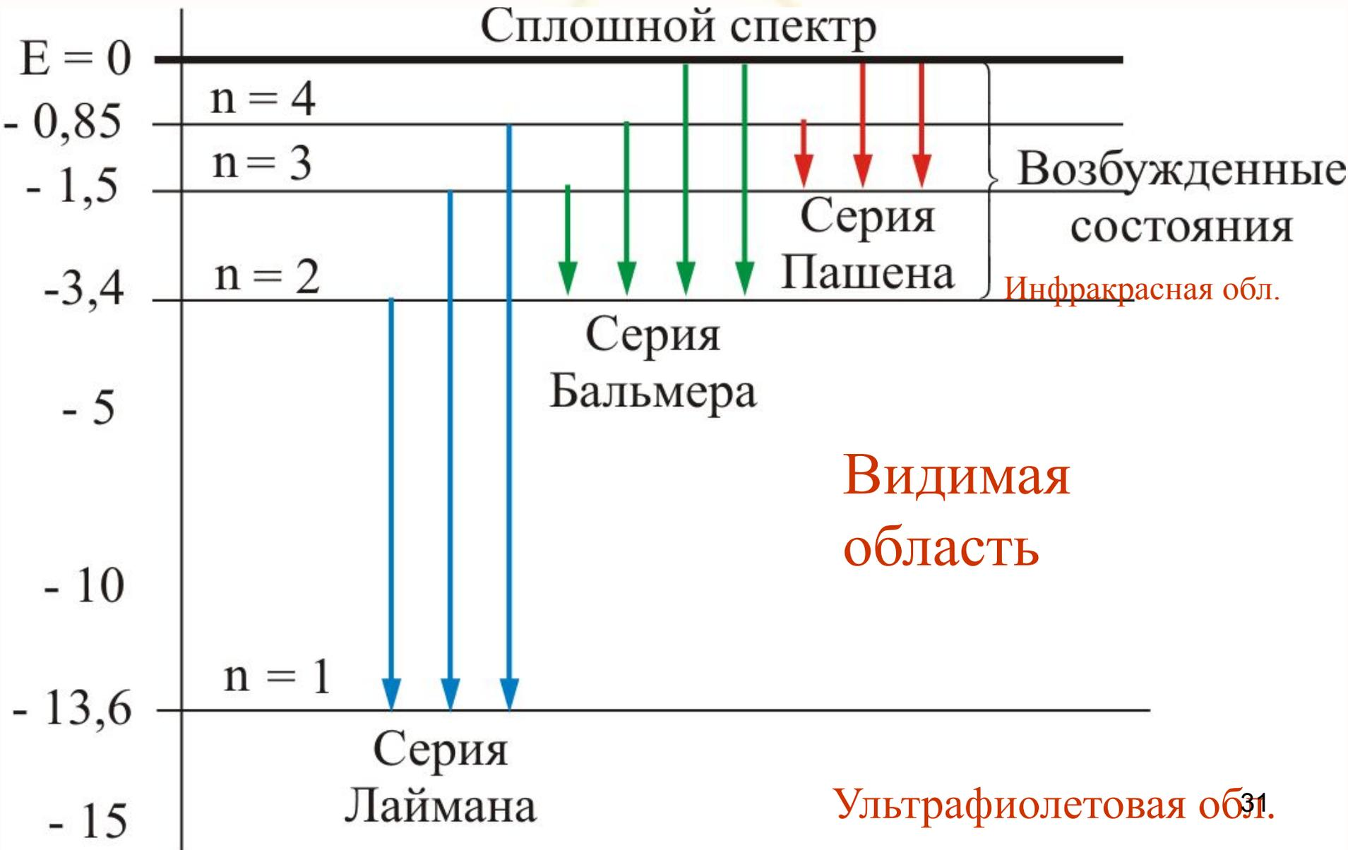
При переходе электрона в атоме водорода из состояния  $n$  в состояние  $k$  излучается фотон с энергией:
