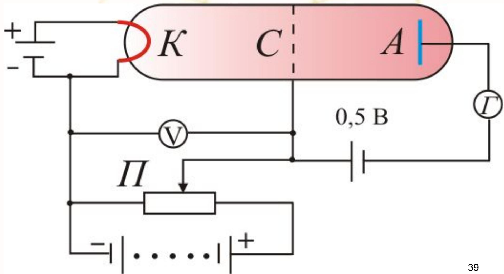
Электронны ускорялись разностью потенциалов  $U$  между катодом и сеткой. Эту разность потенциалов можно было изменять с помощью потенциометра  $\Pi$ . Между сеткой и анодом тормозящее поле ( $\approx 0,5\text{В}$ ).
