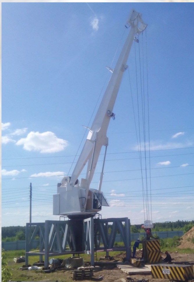
Электрогидравлический судовой специализированный кран с противораскачивающим устройством, г/п 16т., вылет 17,5м.
