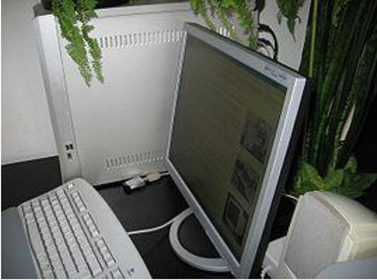
Искажение цветности и контрастности изображения на ЖК-мониторе с малым углом обзора матрицы, при взгляде под малым углом к его плоскости
