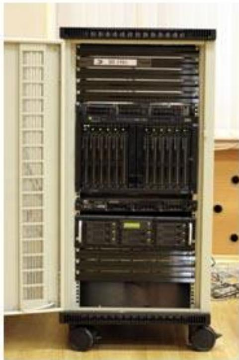
Модель СВК ЕС-1710.03, состоящая из 36 вычислительных узлов и управляющей машины, может достигать пиковой производительности 403,2 Гфлопс. Объем оперативной памяти равняется 72 Гб, а внешней памяти - 3440 Гб. Машины серии СВК ЕС охотно приобретают различные конструкторские бюро, вузы (МГУ, СПбГУ и др.), научно-исследовательские учреждения, ибо западные аналоги стоят намного дороже.
