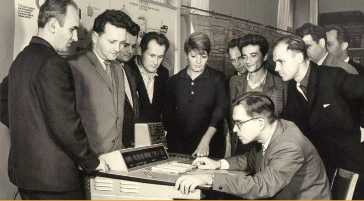
Серия малогабаритных электронных вычислительных машин для инженерных расчётов, одна из первых машин такого класса. В машине использовалась память на металлизированных перфокартах и ступенчатое микропрограммное управление. В серию входили ЭВМ «Проминь», «Проминь-М» (1965) и «Проминь-2» (1967).
