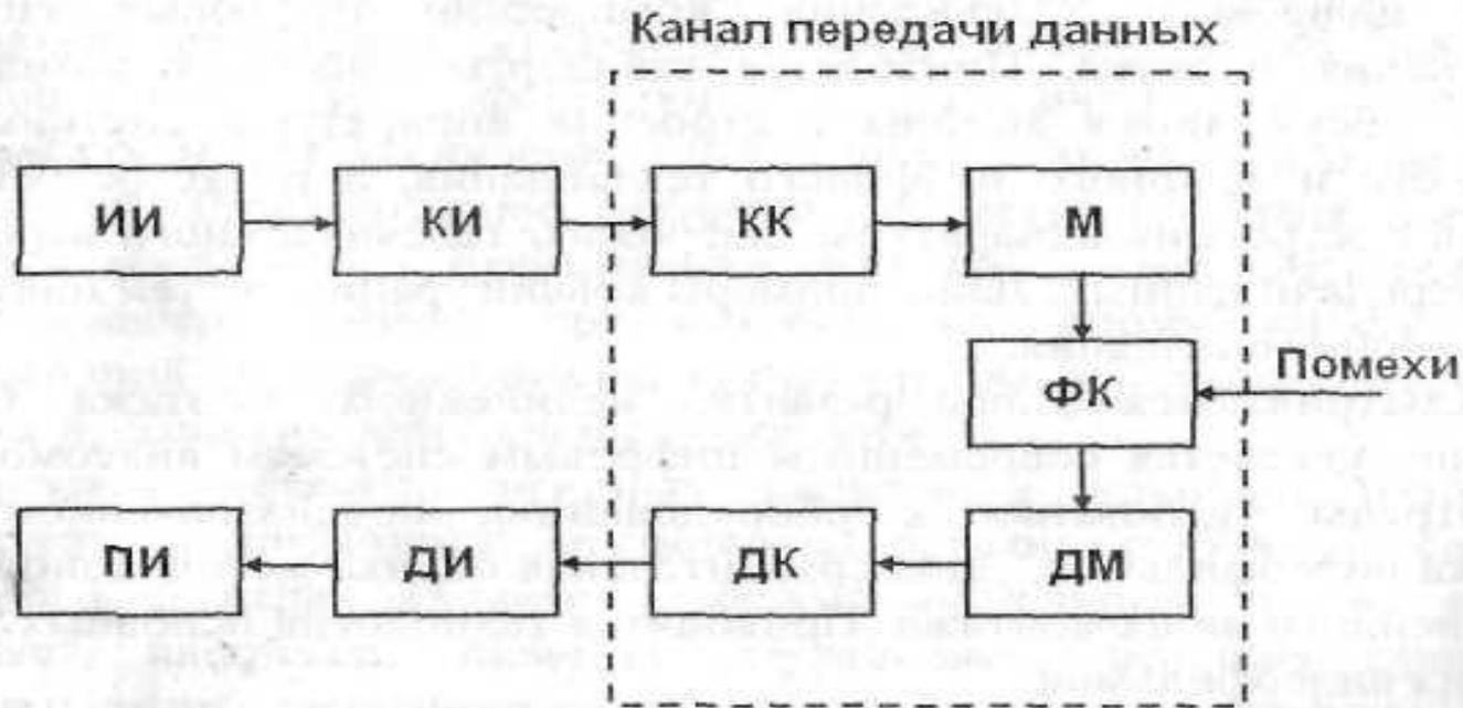
Обобщенная структурная схема системы цифрового телевидения
