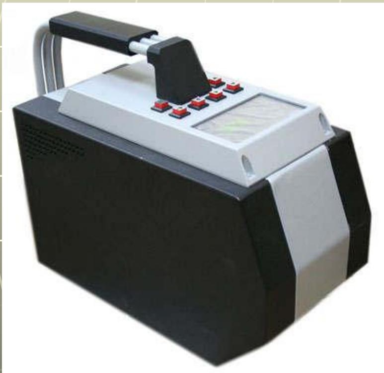
**Детектор паров ВВ на основе дрейф-спектрометра нелинейной подвижности ионов с ионизатором по методу лазерной десорбции.**
