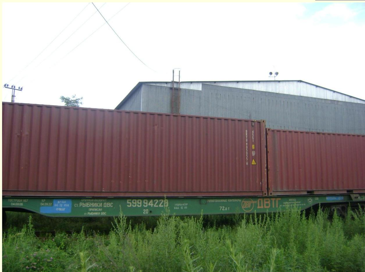
Контейнерные перевозки это способ транспортирования грузов с использованием грузовых контейнеров, обеспечивающую без перегрузочную доставку от склада
