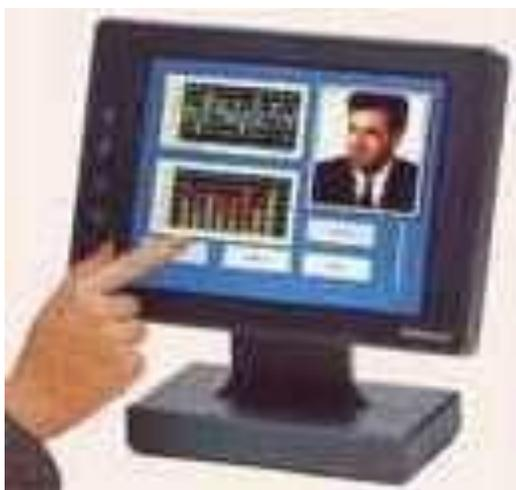
В этих типах мониторов общение с компьютером осуществляется путём прикосновения пальцем к определённому месту чувствительного экрана. Этим выбирается необходимый режим из меню, показанного на экране монитора. (Меню — это выведенный на экран монитора список различных вариантов работы компьютера, по которому можно сделать конкретный выбор.) Сенсорными экранами оборудуют рабочие места операторов и диспетчеров, их используют в информационно-справочных системах и т.д..
