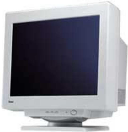
Изображение на экране монитора создается пучком электронов, испускаемых электронной пушкой. Этот пучок электронов разгоняется высоким электрическим напряжением (десятки киловольт) и падает на внутреннюю поверхность экрана, покрытую люминофором (веществом, светящимся под воздействием пучка электронов)
