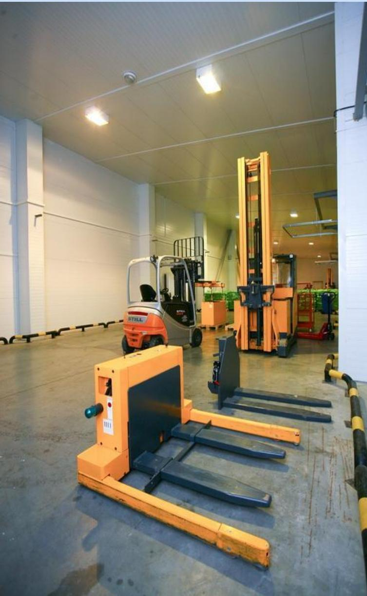
*предназначена для поступления продукции в холодильный терминал. Приемка товара предусмотрена с железнодорожного транспорта. Вагоны подаются непосредственно к рампе терминала. С помощью погрузчиков немецкого концерна Still, через шлюзовую систему, поддоны с продукцией подаются на хранение в холодильный терминал.*
