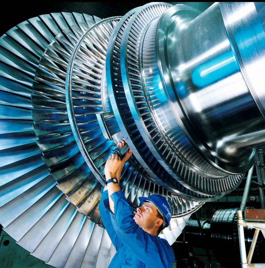
Ротор современной паровой турбины производства Siemens AG, применяемой для генерации электроэнергии
