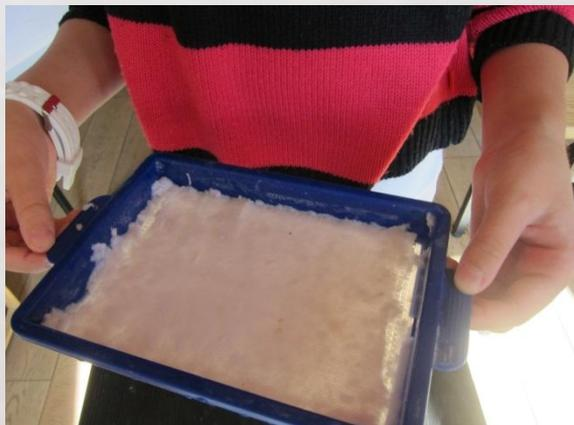
7. Осторожно убираем верхнюю сетку, переворачиваем сито и выкладываем слой на стол
