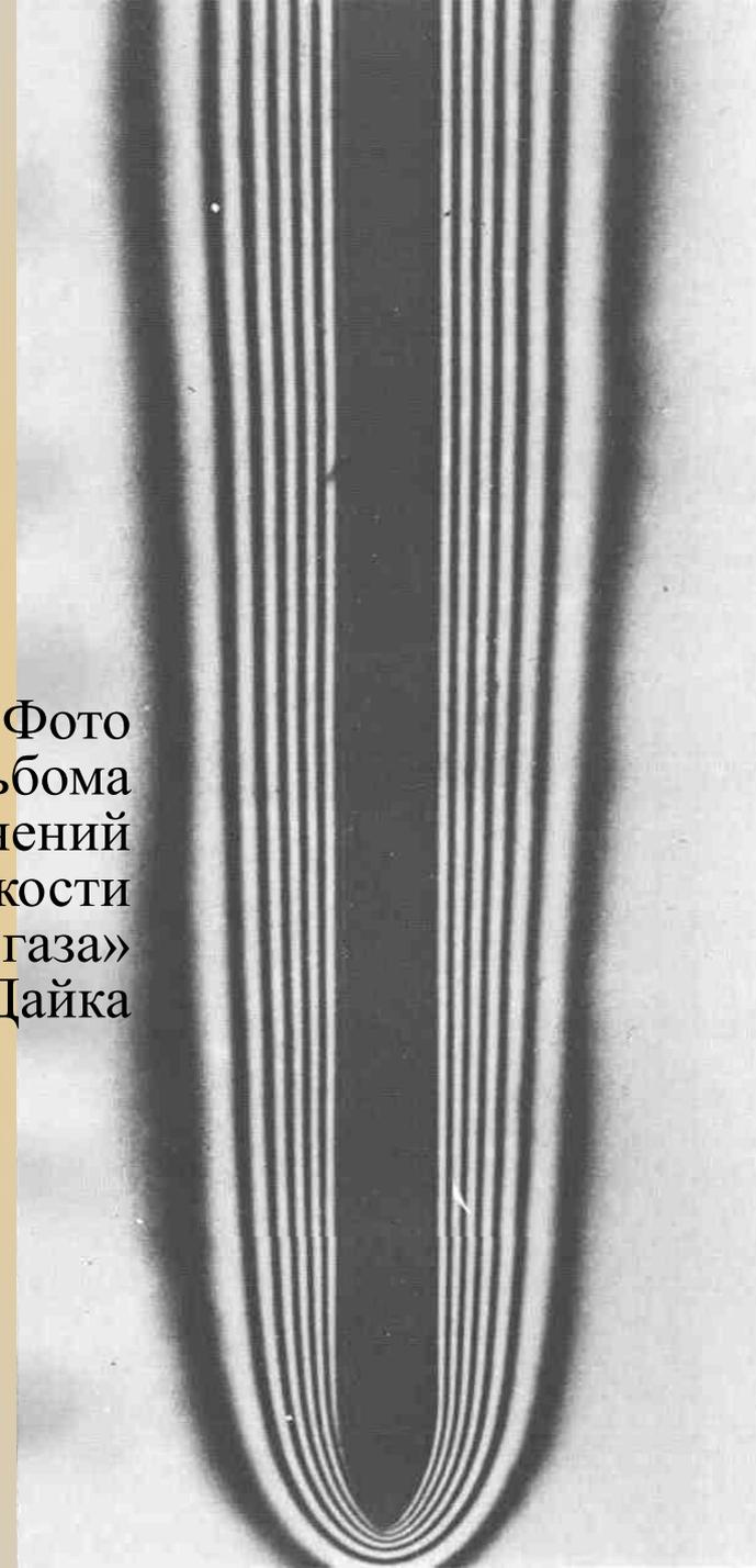
**Свободная конвекция от вертикальной пластинки.**
