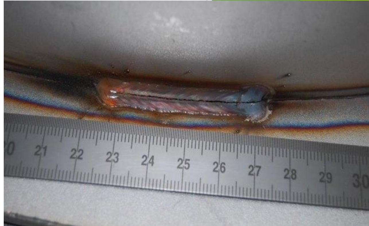
Нарушение технологических особенностей сварки высокоуглеродистых сталей приводит к дефектам сварочного шва.
