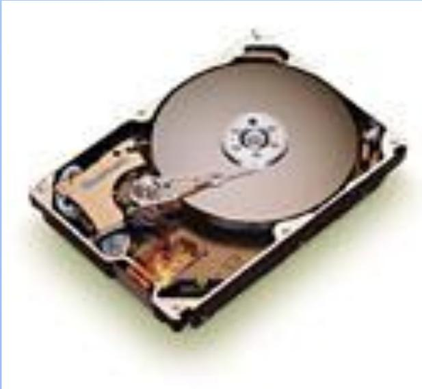
Носителями информации являются круглые пластины — **платтеры**, обе поверхности которых покрыты слоем магнитного материала. Используется для постоянного хранения информации — программ и данных.
