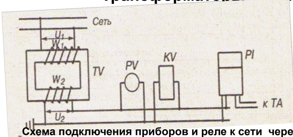
Схема подключения приборов и реле к сети через однофазный трансформатор напряжения
