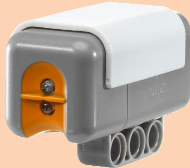
С помощью датчика освещенности робот способен отличать свет от темноты настолько хорошо, насколько позволяет освещение в комнате. Датчик может по яркости отраженного света различать цвета (градации по шкале серого).
