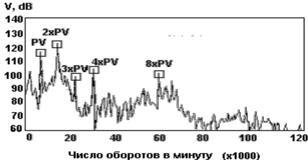
В центробежных насосах всегда отчетливо видна лопаточная составляющая, и она возрастает в случае появления дефектов лопастей, таких как деформации, трещины или поломки. На рисунке показан такой спектр, где PV- обозначает лопаточную частоту, т.е. частоту вращения, умноженную на число лопаток колеса насоса.
