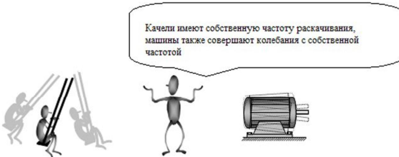
Если на машину будет действовать внешняя периодическая сила с частотой близкой к её собственной частоте колебаний, амплитуда колебаний будет постепенно увеличиваться. В этом случае машина, испытывает резонанс.
