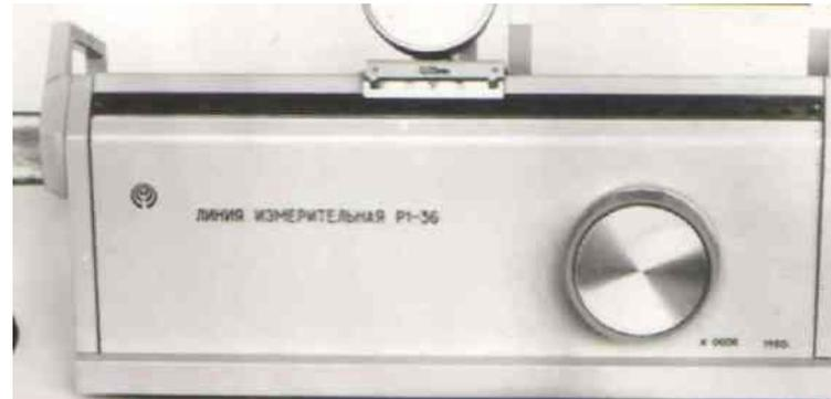
Рисунок 4.2 – Измерительная линия на основе отрезка коаксиального кабеля
