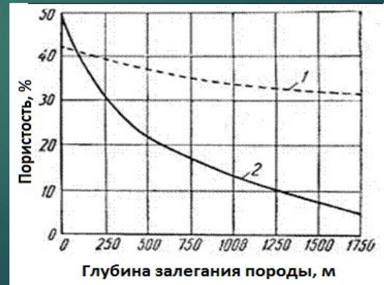
Отношение суммарного объема пор к общему объему образца породы называется **коэффициентом полной пористости**.
