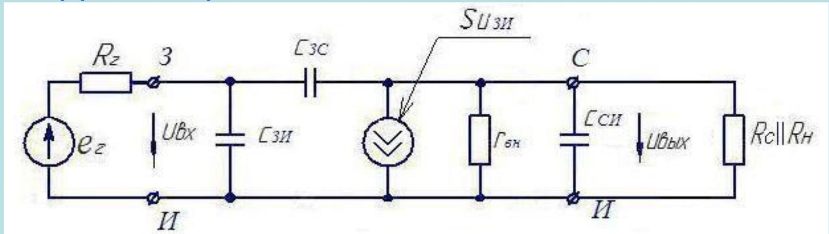
$$i_{вх} = j\omega C_{зп} u_{вх} + j\omega C_{зс} (u_{вх} - u_{вых}) \quad i_{вх} = j\omega C_{вх}$$
