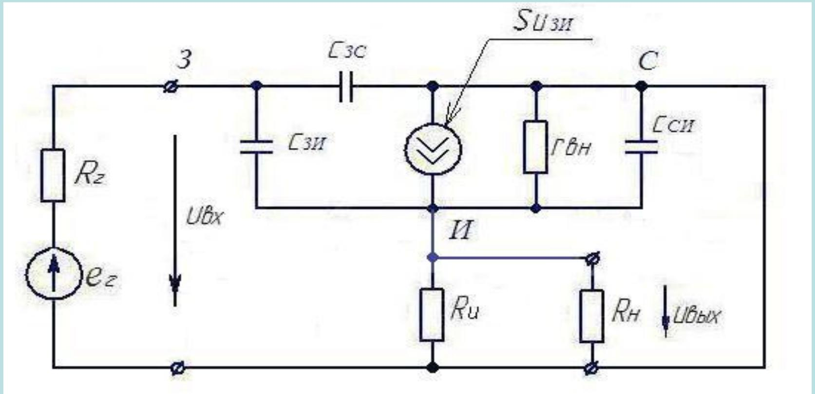
$$i_{вх} = j\omega C_{зс} u_{вх} + j\omega C_{зи}(u_{вх} - u_{вых})$$
