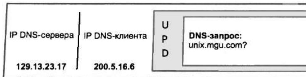
Рис. 2. IP-пакет с инкапсулированным в него DNS-запросом.
