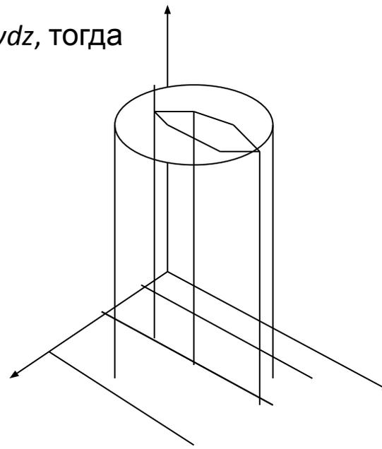
Опишем около  $T$  цилиндрическую поверхность с образующей, перпендикулярной к плоскости  $OXY$ .
