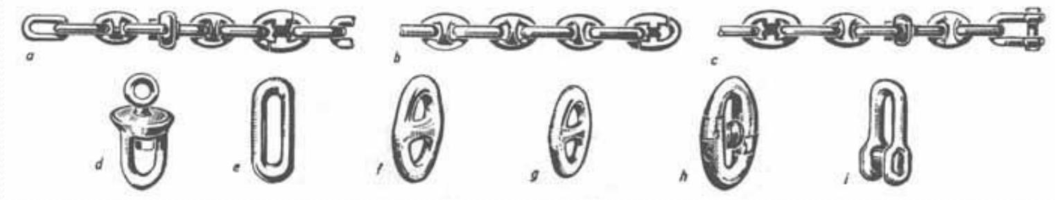
а — смычка якорной цепи (с якорной скобой); б — промежуточная смычка; в — коренная смычка; д — вертлюг; е — длинное звено; ф — большое звено; г — обыкновенное звено; h — звено с распоркой; и — концевая скоба.
