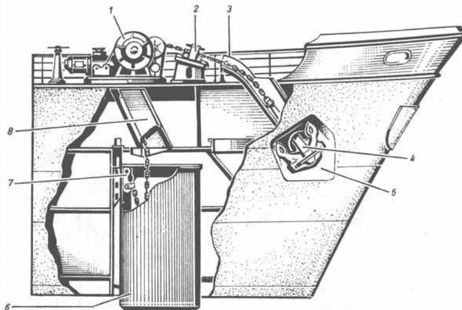
1 — якорная лебедка (брашпиль); 2 — стопор для якорной цепи; 3 — труба якорного клюза; 4 — якорь; 5 — якорная ниша; 6 — цепной ящик; 7 — устройство для крепления якорной цепи; 8 — цепная труба.
