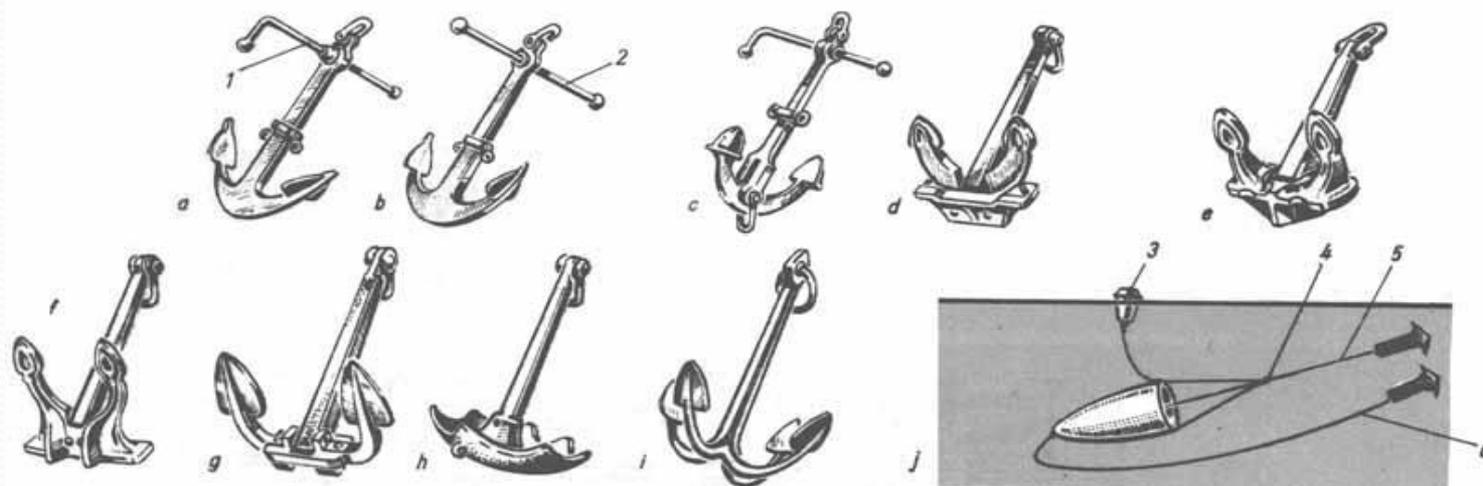
а, б — шток-анкер; с — якорь Тротмана; d — якорь Холла; е — якорь Грузона; f — якорь Шпека; g — клипперский якорь со штоком и поворотными лапами (якорь Мартина); h — грибовидный «мертвый» якорь; i — дрек, кошка, верт; j — плавучий якорь ; t — откидной шток; 2 — неподвижный шток; 3 — буй; 4 — шпрюйт; 5 — якорный трос; 6 — сорлинь.
