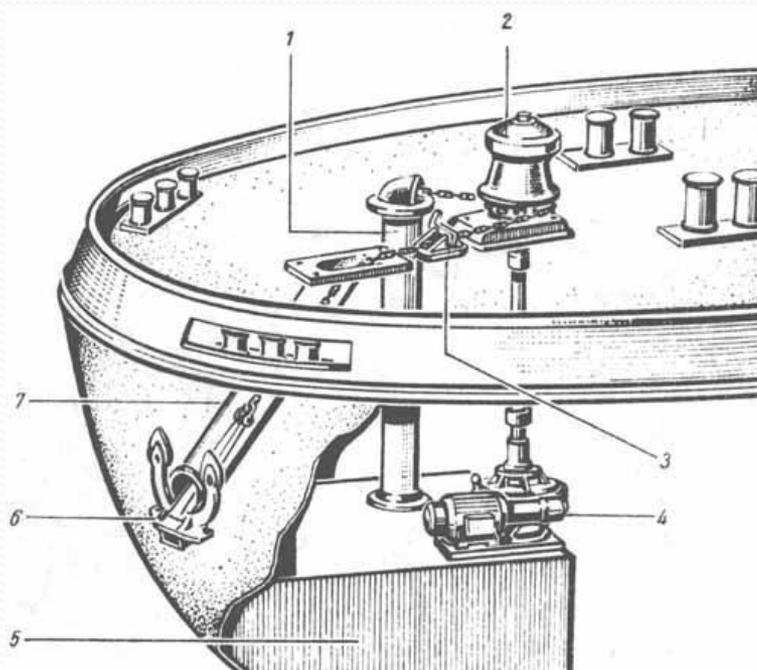
1 — цепная труба; 2 — якорный шпиль; 3 — стопор для якорной цепи; 4 — двигатель; 5 — цепной ящик; 6 — якорь; 7 — труба якорного клюза.
