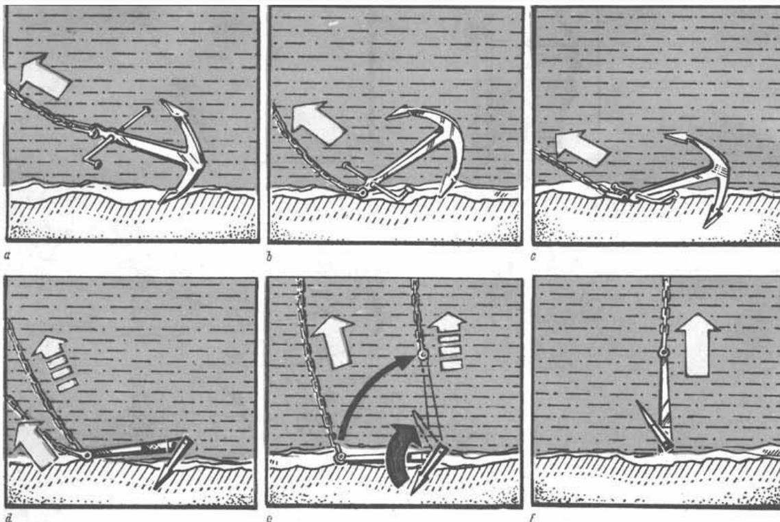
а — якорь скользит по грунту; б — якорь зацепляется; в — якорь зарывается; д — якорная цепь натягивается; е — якорная цепь вырывает якорь из грунта; ф — якорь поднимается
