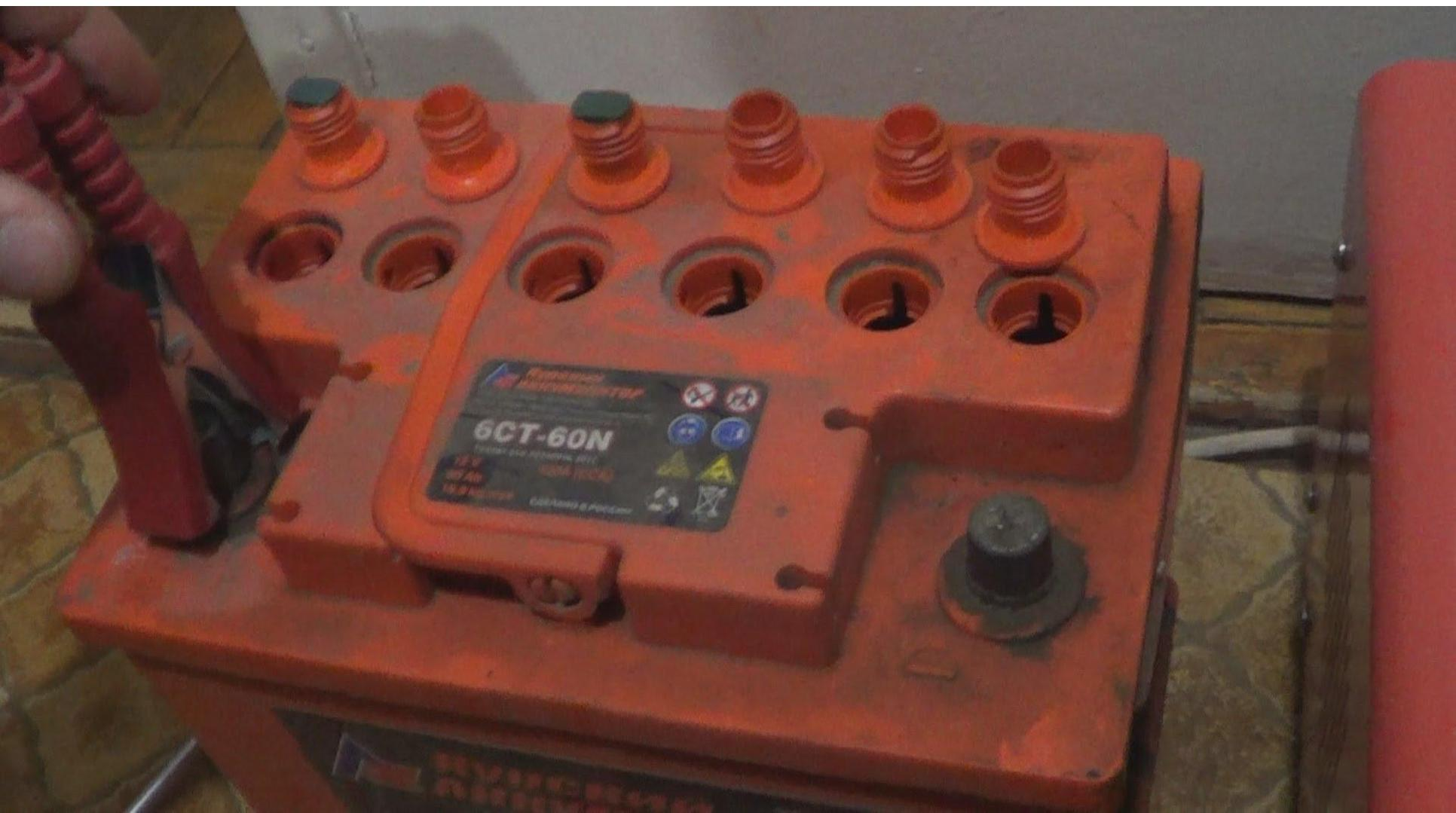
Каждый отсек моноблока закрывается крышкой, в которой имеется отверстие для заливки электролита и контроля его уровня. Заливочные отверстия закрываются вентиляционной пробкой с отражателем, предохраняющим электролит от выплескивания во время движения.
