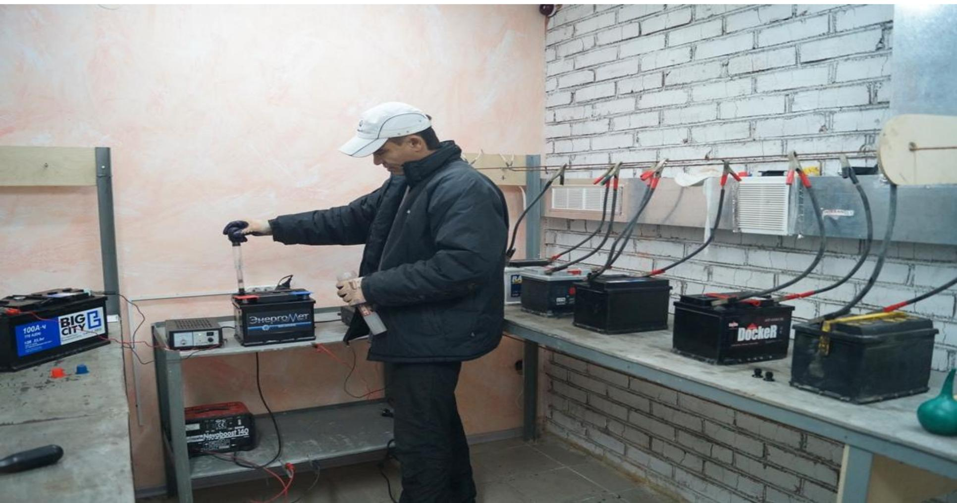
Плотность электролита, приведенная к температуре 25 °С, для полностью заряженной батареи должна составлять 1,23... 1,30 г/см<sup>3</sup>. В центральных районах плотность электролита в летнее и зимнее время должна быть 1,27 г/см<sup>3</sup>, а в южных 1,25 г/см<sup>3</sup>. В районах Крайнего Севера ее увеличивают зимой до 1,30 г/см<sup>3</sup>, а летом уменьшают до 1,27 г/см<sup>3</sup>. При полном разряде батареи плотность электролита снижается на 0,15...0,17 г/см<sup>3</sup>
