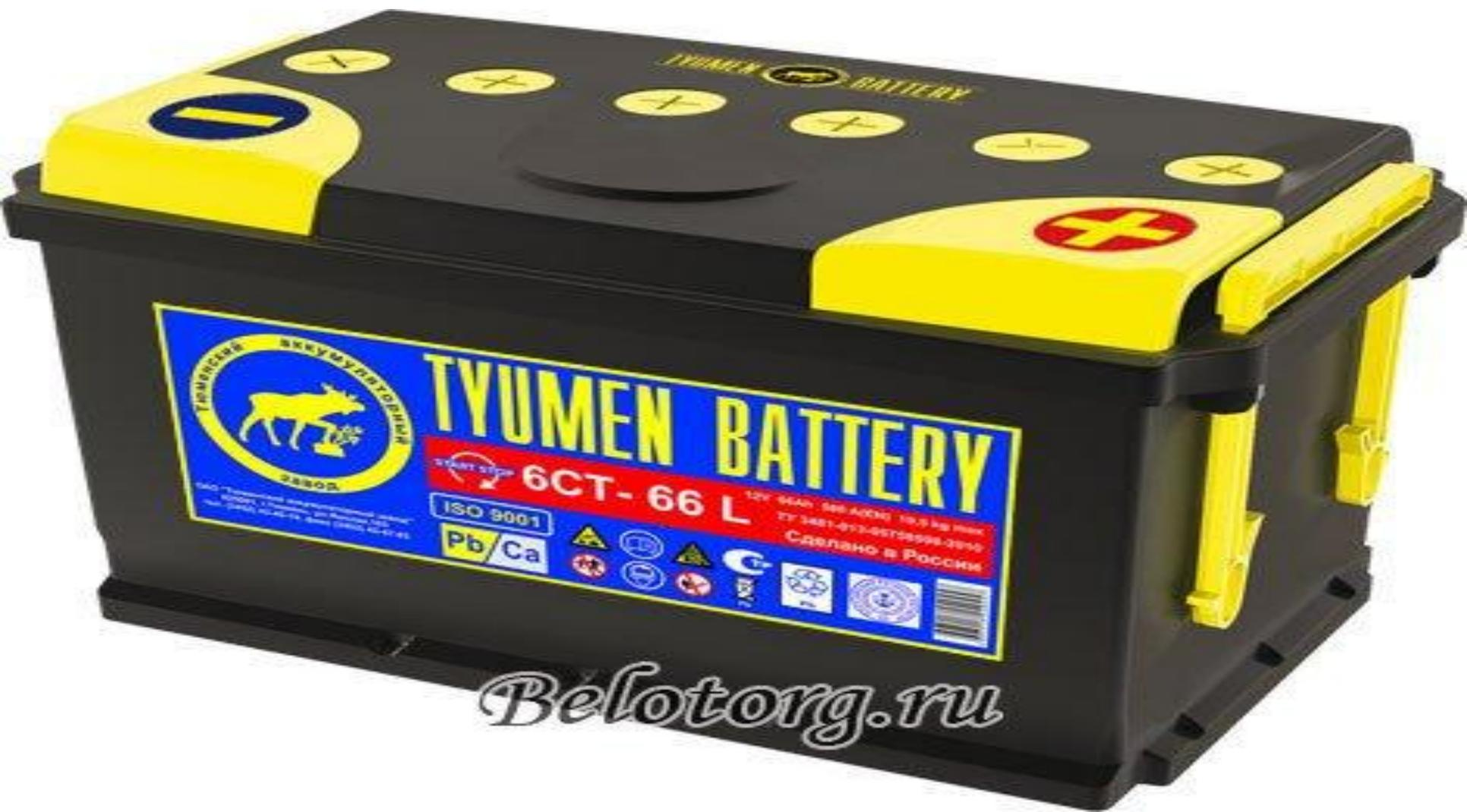
Первая цифра маркировки означает число последовательно соединенных аккумуляторов в батарее, буквы СТ — батарею стартерного типа; число 90 — номинальную емкость батареи в ампер-часах при 20-часовом режиме разряда, буквы ЭМ — материал моноблока (Э — эбонит, Т — термопласт) и сепараторов (М — мипласт, Р — мипор, С — стекловолокно); буква Н означает, что батарея несухозаряженная
