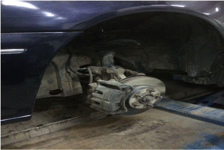
Монтаж пластины на стойку автомобиля Nissan Presage
