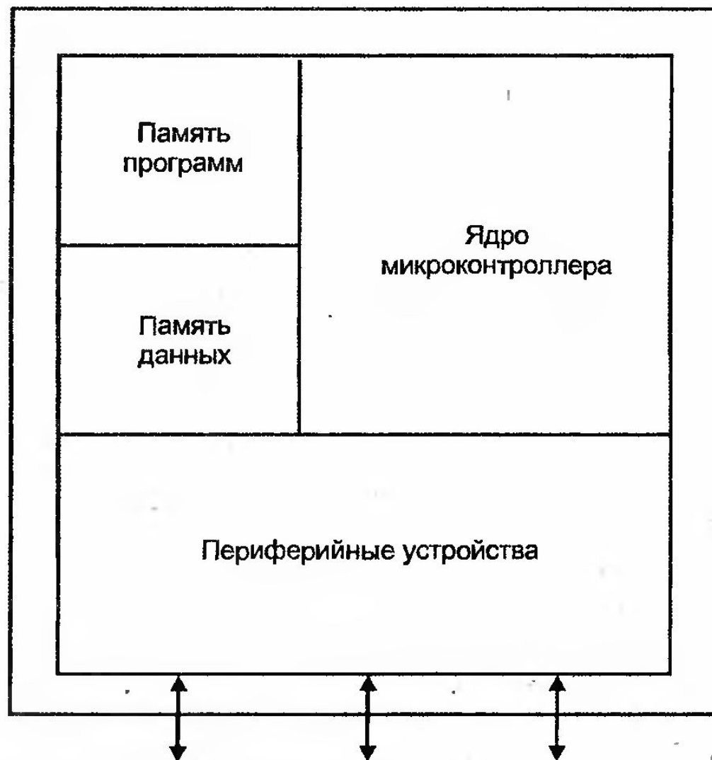
Рис. 1.1. Обобщенная структурная схема микроконтроллера
